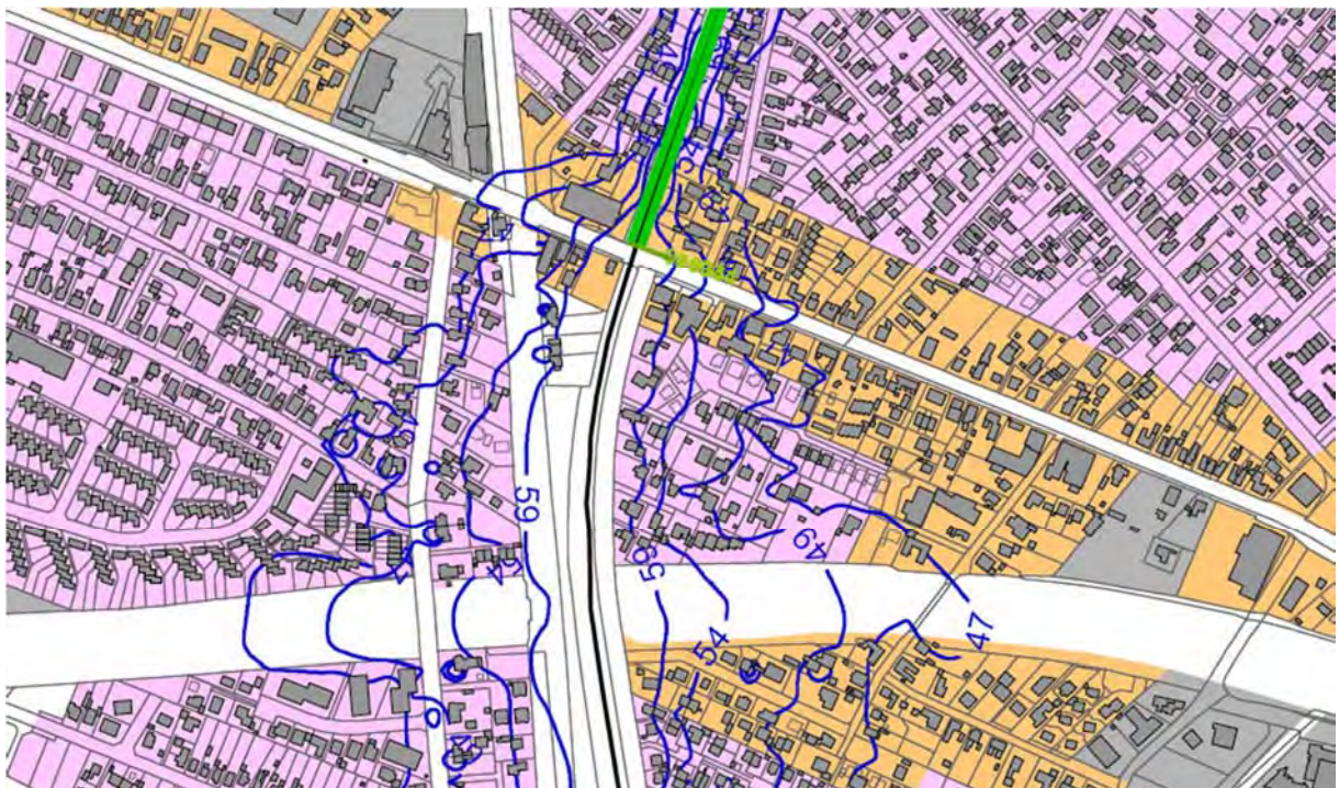
Abbildung 22: Hemmelsberger Kurve im Bereich BÜ Bremer Heerstraße mit Lärmschutzwänden (grün dargestellt) gemäß Planung IBK [IBK 2013]
