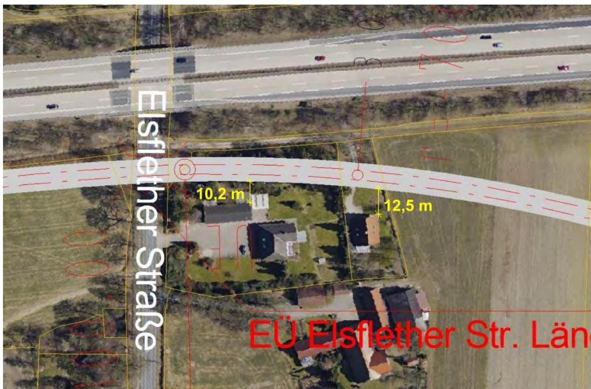
Abbildung 20: Minimale Abstände Trasse – Gebäude im Bereich Elsflether Straße, Quelle: VWI
