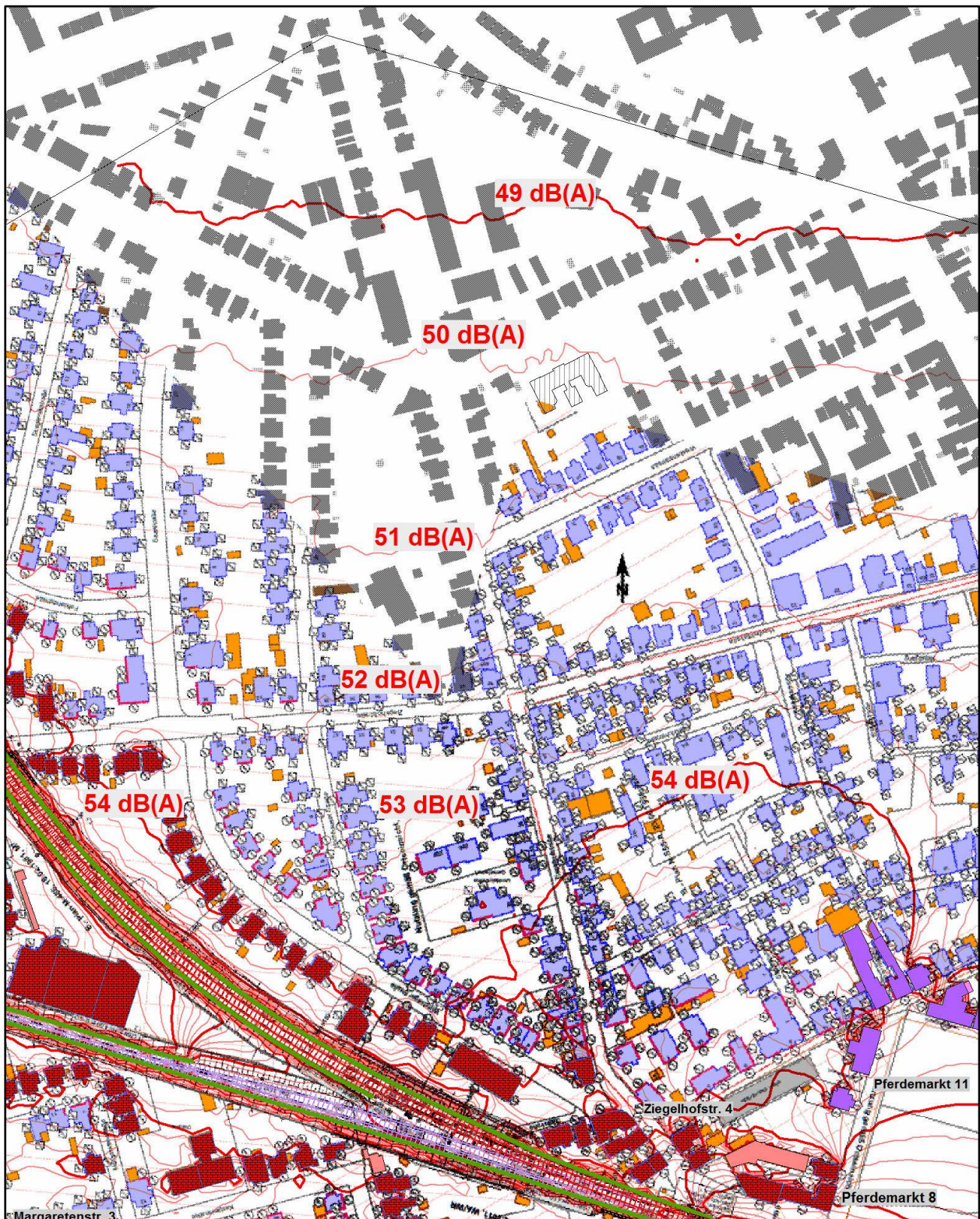
Abbildung 13: Rasterberechnung Nacht; Bereich Würzburger Straße / Falklandstraße für eine Immissionshöhe von 5,9 m über Grund. Die blau markierten Gebäude stellen die im PFA 1 untersuchten Gebäude dar. Für die rot markierten Fassaden an den Gebäuden ist ein grundsätzlicher Anspruch auf Lärmschutz ermittelt worden.
