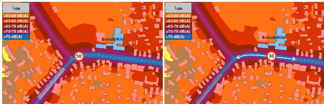
Abbildung 2: Darstellung des Lärmindex  $L_{DEN}$  bei unterschiedlichen zulässigen Geschwindigkeiten im Bereich eines Schulstandortes. Veränderungen der Pegelbänder sind kaum signifikant und allenfalls an den Stellen zu bemerken, wo eine ungehinderte Schallausbreitung vorliegt.
