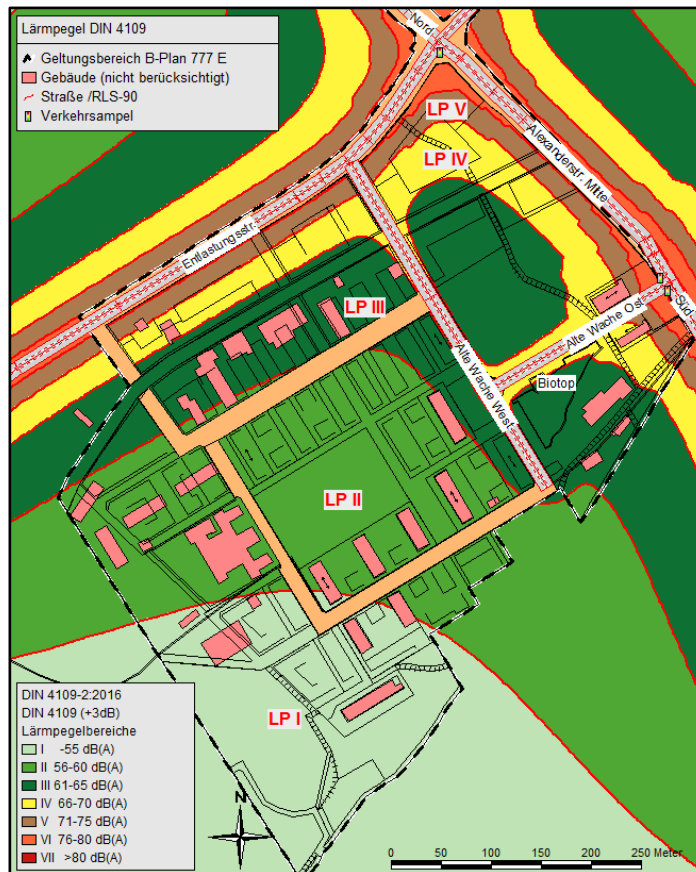
Abb. 5: Lärmpegelbereiche nach DIN 4109 für die 1. Obergeschosssebene unter Zugrundelegung der prognostizierten Verkehrsdaten der Tabelle 1 und der Tabelle 2 (s. Gutachten). Die Darstellung der Lärmpegelbereiche ist auch in der Planzeichnung dargestellt.
