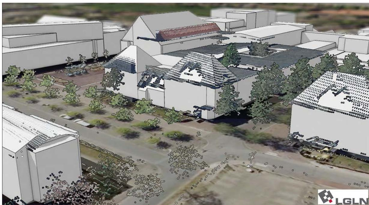
Abbildung 35: Einfärbte Punktewolke aus den 3D-Messdaten in Kombination mit 3D-Gebäudemodellen des LGLN im Bereich Industriestraße/Escherweg, Quelle: NWP
